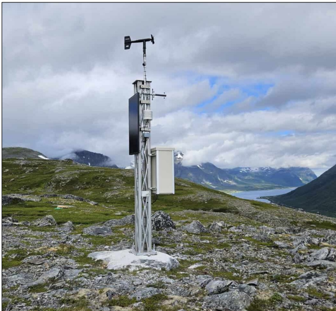
Figur 2: Eksempel på værstasjon på Lattix-mast på skredvarslingsprosjekt på Arnøya i Troms. Lignende værstasjon må settes opp innenfor nasjonalparkgrensene, som beskrevet i Tabell 1. Foto: Skred AS.
