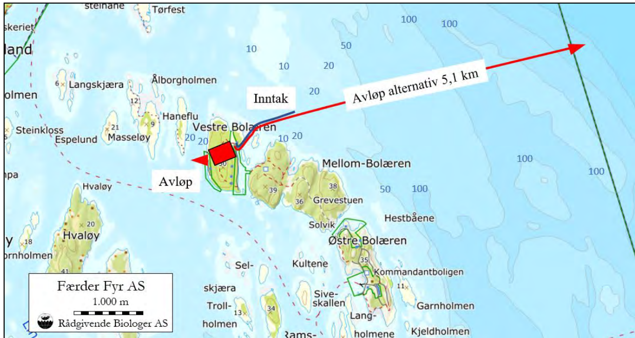
Figur 1. Planer for landbsert oppdrett i fjellhaller på Vestre Bolæren. Vanninntak tenkes lagt til 25 m dyp mot øst, og avløp til 20 meters dyp ved kai på vestsiden, alternativt med 5,1 km lang avløpsledning ut av nasjonalparken mot øst.
