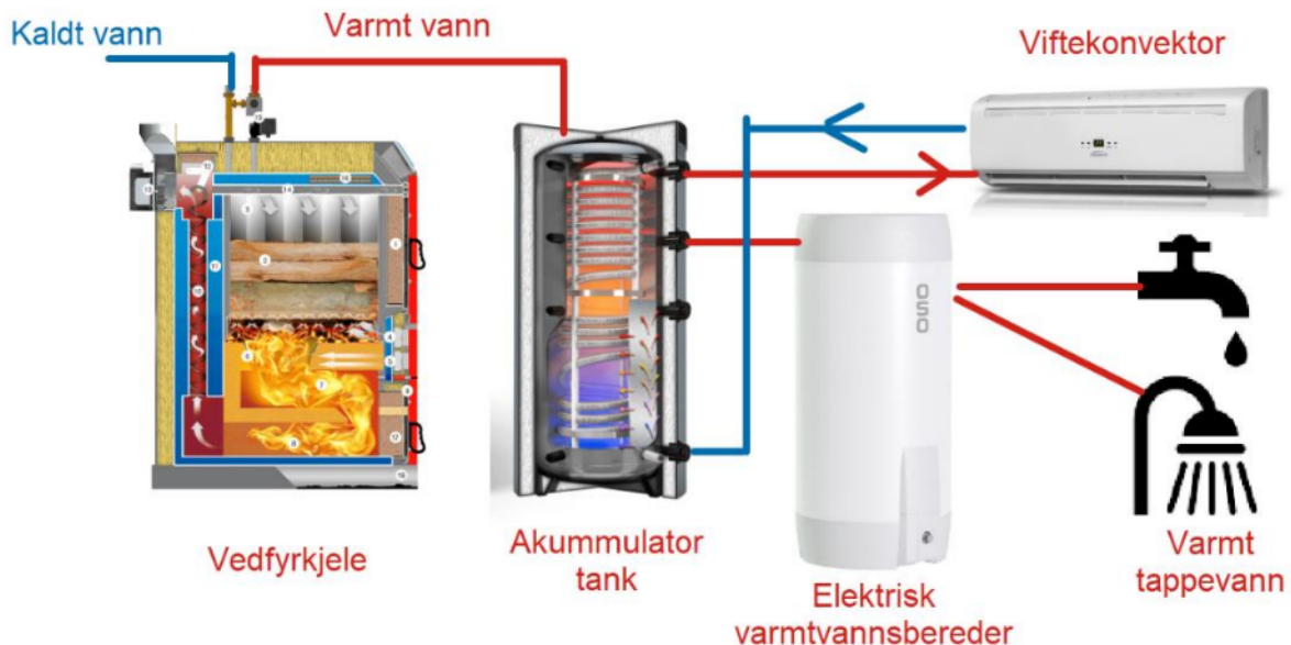
Figur 4 Prinsipp for oppvarming med vedkjele og spissoppvarming med elektrisitet.
