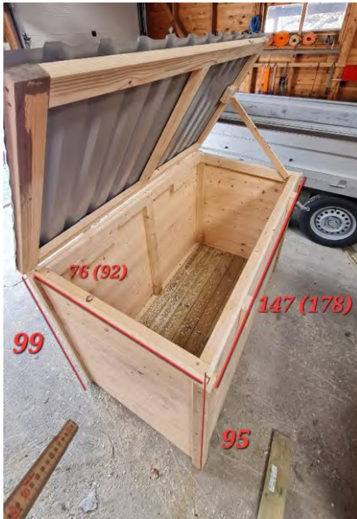
Figur 2: Utforming og mål på tiltenkt vedkasse, fra søknad.
