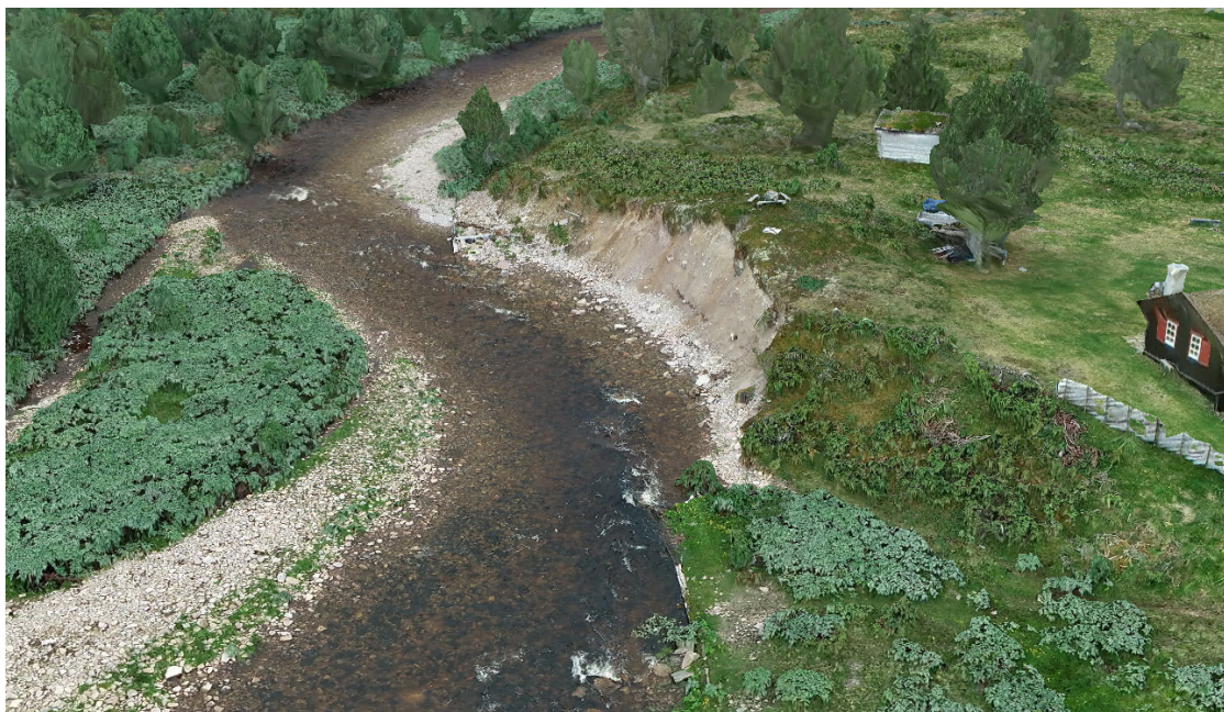
Figur 8 viser 3D-modell produsert fra dronebilder.
