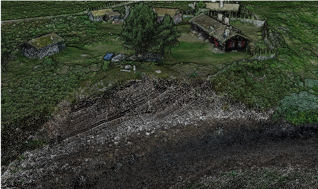
Figur 3 viser en punktsky (fra fotogrammetri) med individuelle punkter (XYZ) med farge.
