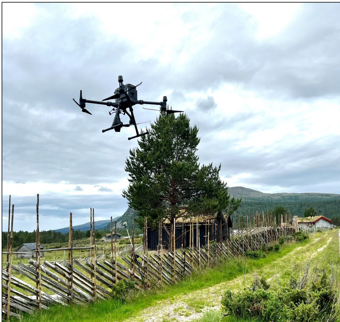
Figur 2 viser dronen DJI M300 RTK med LiDAR-sensor Zenmuse L1.
