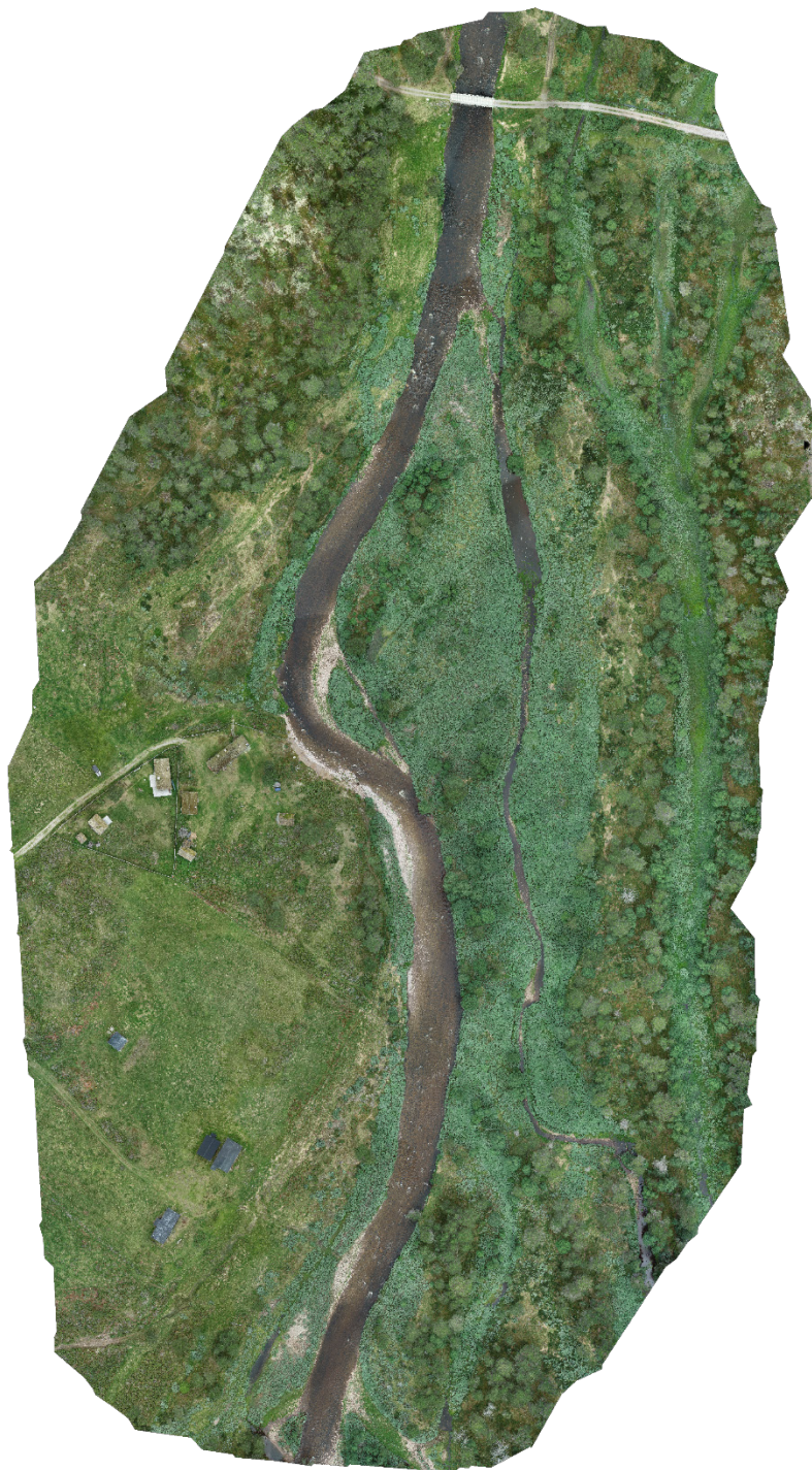
Figur 7 viser rektifiserte flybilder (ortofoto) som er sydd sammen til en mosaikk.
