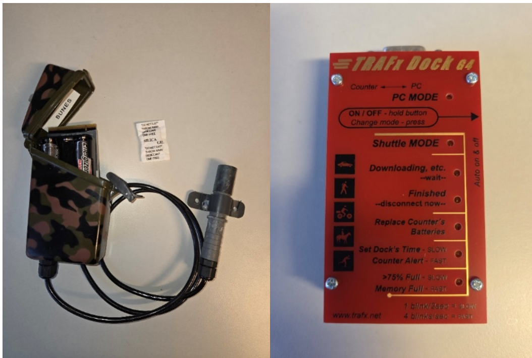
Figur 1. Til venstre, ferdselstelleren og tørkemiddelpose som alltid ligger i beholderen for å unngå fuktdanning. Til høyre, docken som bl.a. brukes til å laste ned data fra telleren.
