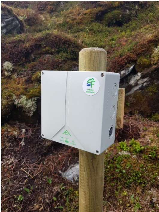
Figur 3. Montering av synlig teller. Koblingsboks montert på en stolpe langs med en sti. Sensor er montert slik at den registrerer ferdsel gjennom hull i koblingsboksen. Det anbefales at det festes informasjon om prosjektet og eier på boksen, når den skal stå synlig. Denne telleren er montert av Lofoten Friluftsråd.
