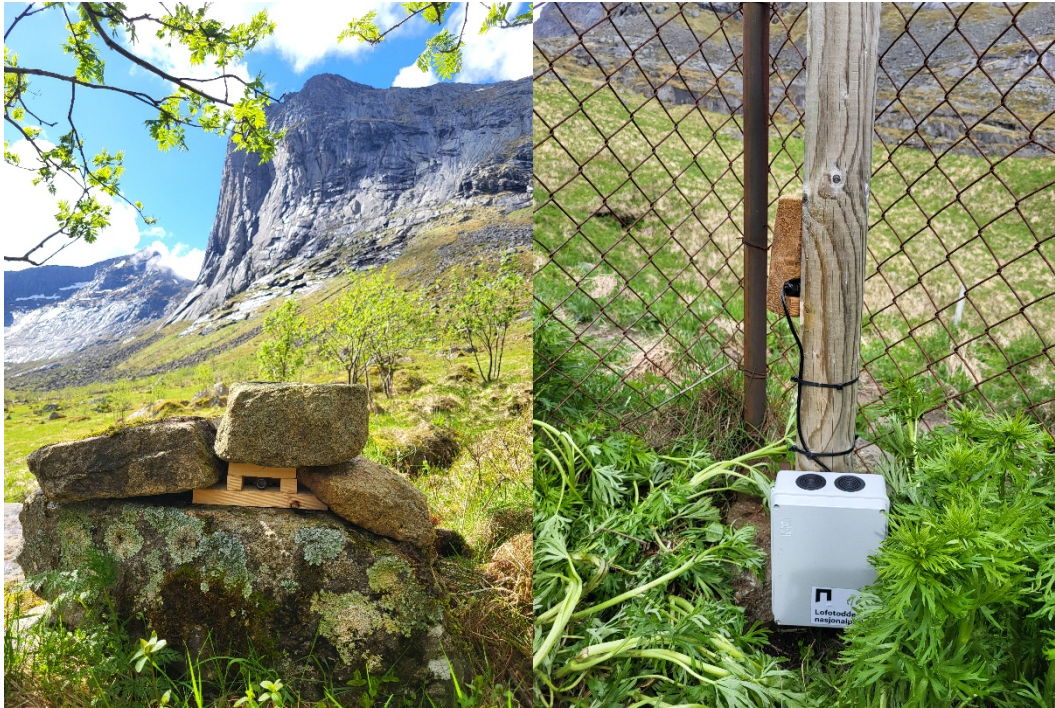
Figur 2. Montering av «skjult» teller langs med sti. Til venstre, teller skjult i en varde. Til høyre, teller montert på en gjerdestolpe, der batteriholderen ligger i en koblingsboks montert bak stolpen.
